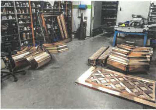
Nakra-Schatzkammer: Die Uhrenrahmen, Rautenornamente, Jalousieprofile und Gesimskränze stehen bereit für den Transport nach Flensburg und die Montage vor Ort
